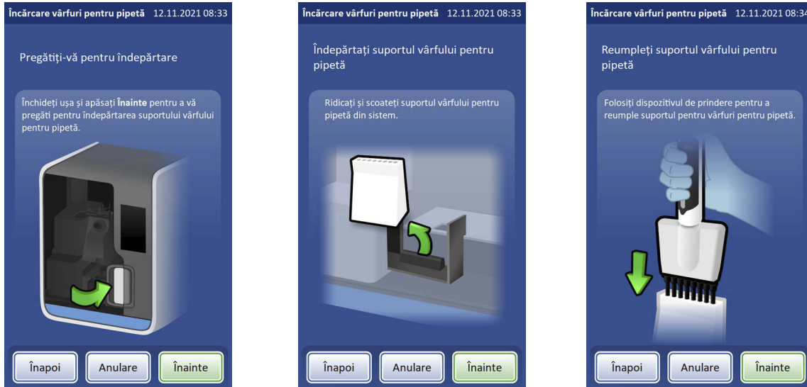
Figura 7-11 Încărcarea vârfurilor pentru pipetă în suportul vârfurilor pentru pipetă
