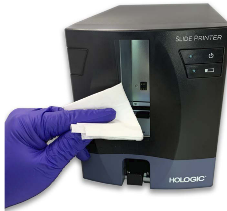
Figura 8-11 Curățarea rolei de intrare de pe imprimanta pentru lame
