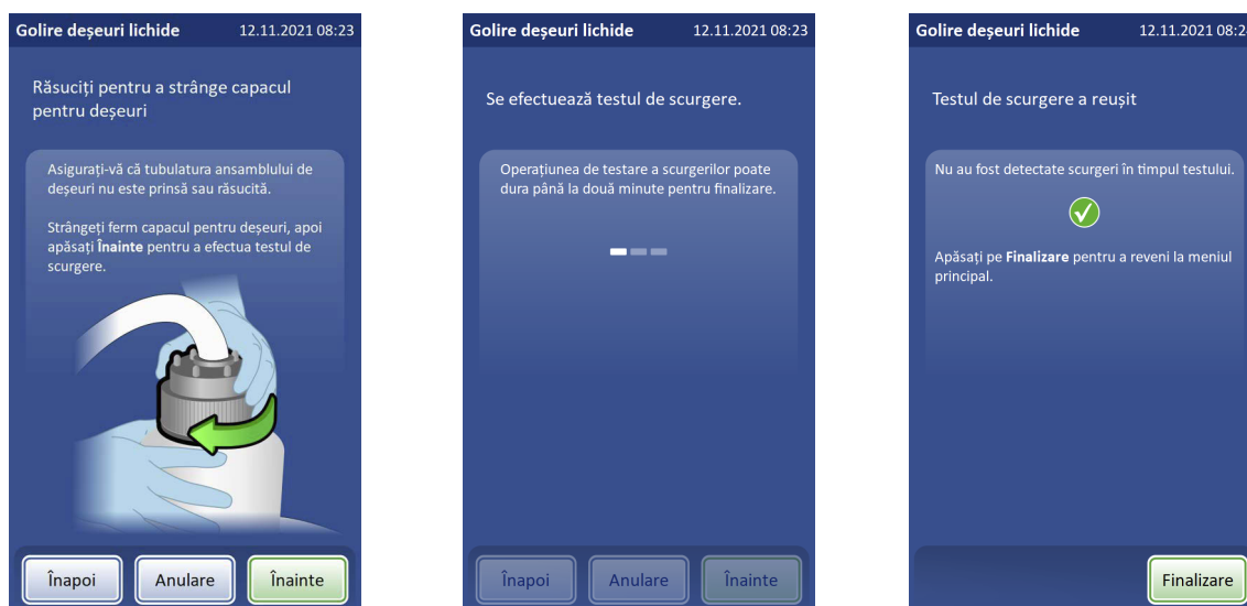
Figura 8-17 Strângerea capacului și efectuarea testului de scurgere a sistemului de deșeuri
