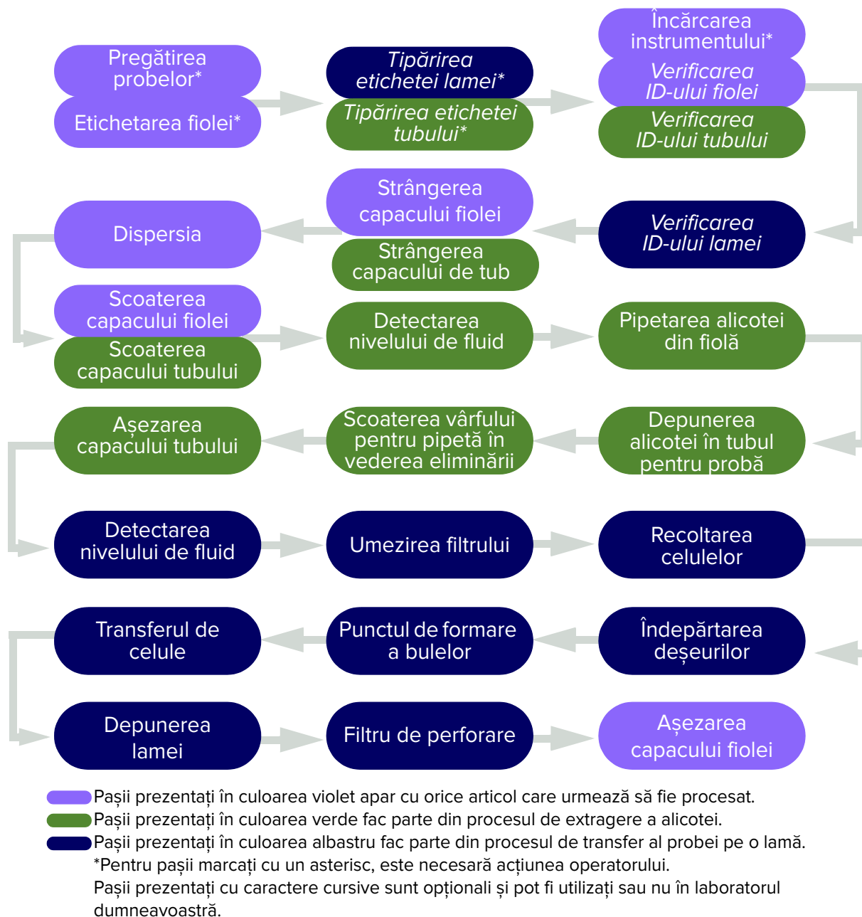
Figura 1-3 Procesarea lamei și extragerea alicotei pe procesorul ThinPrep™ Genesis™
