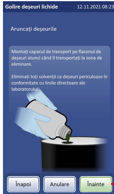
Figura 8-15 Eliminarea conținutului sticlei pentru deșeuri
