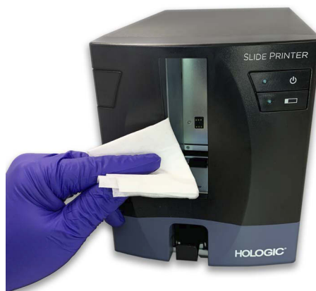
Rycina 8-11 Czyszczenie rolki wprowadzającej drukarki szkiełek
