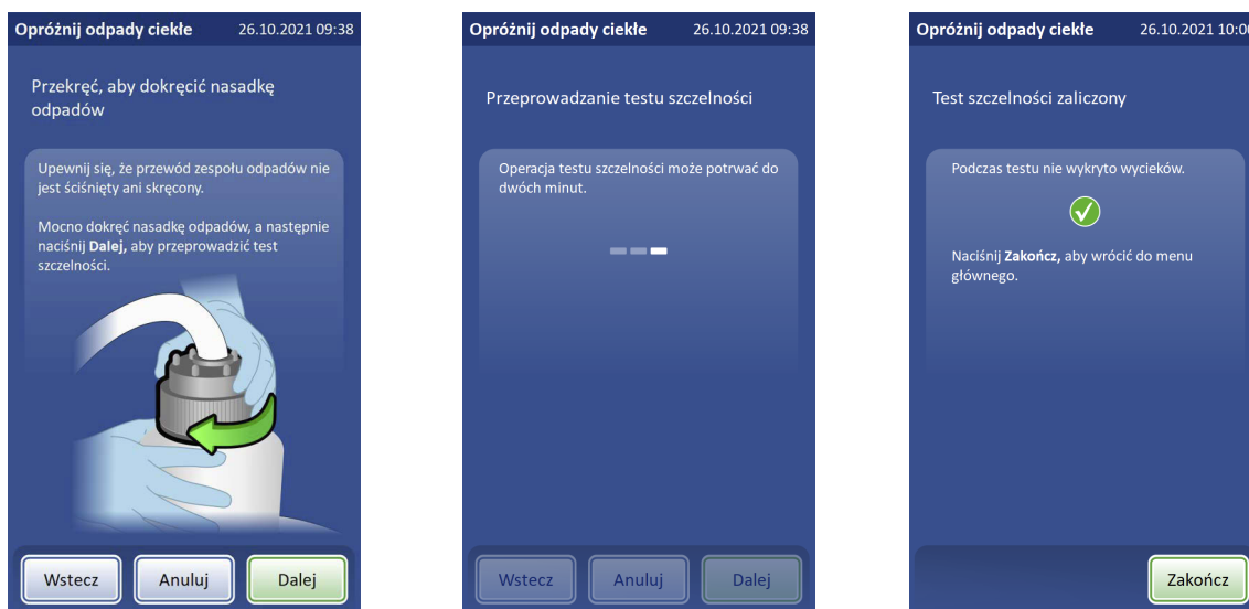
Rycina 8-17 Dokręcenie nasadki i wykonanie testu szczelności systemu odpadów
