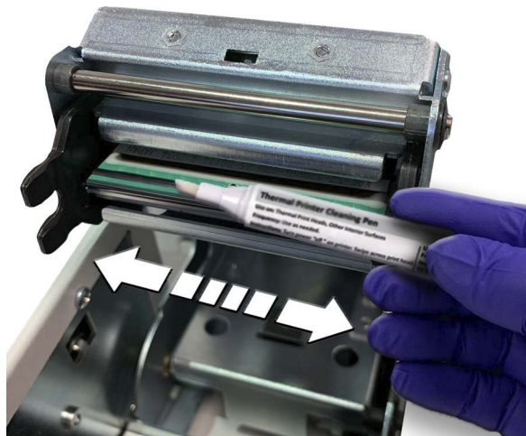
Фигура 8-7 Избършете писалката за почистване през печатащата глава на принтера за предметни стъкла
