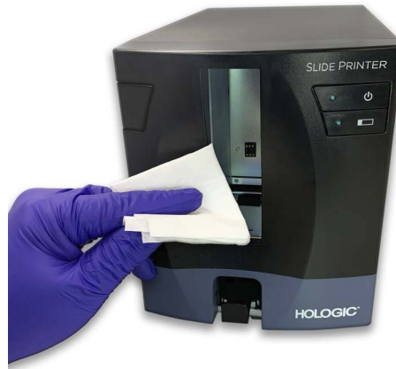
Фигура 8-11 Почистете входната ролка на принтера за предметни стъкла
