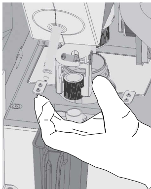
Фигура 9-9 Освободете капачката на епруветката
