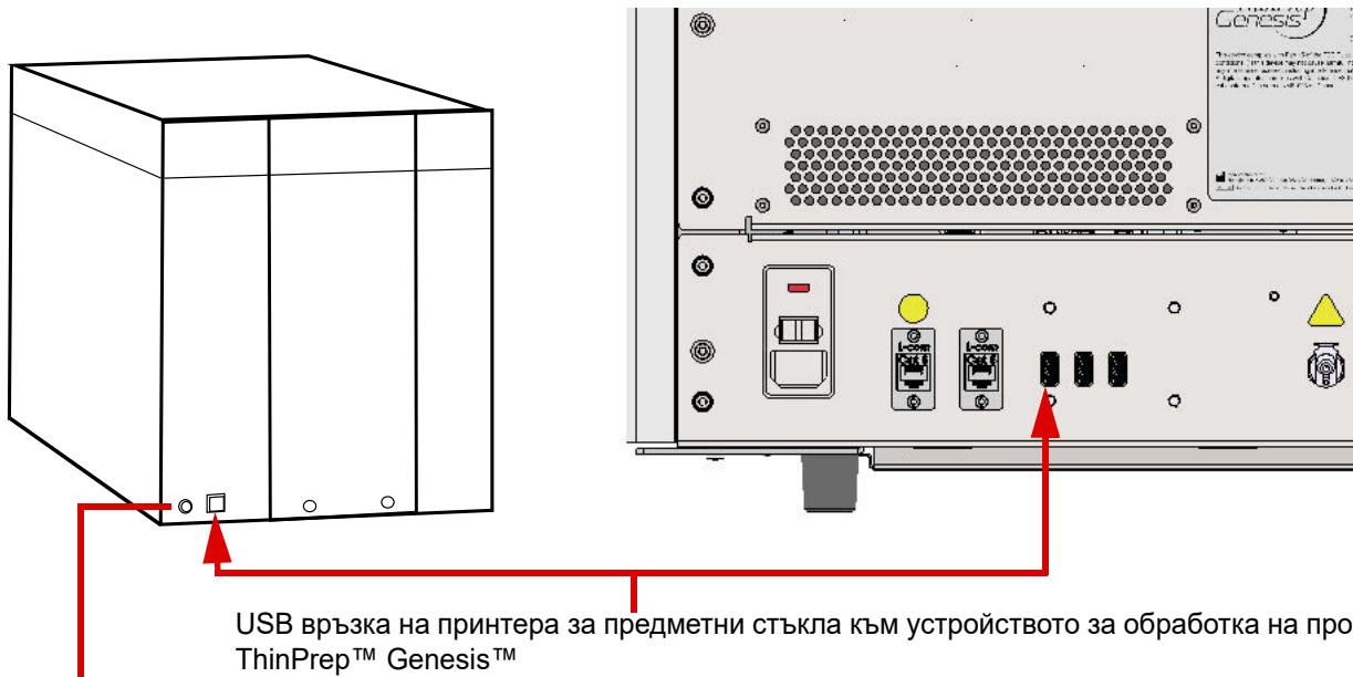
Фигура 8-26 Свържете принтера за предметни съгла към устройството за обработка на проби ThinPrep™ Genesis™
