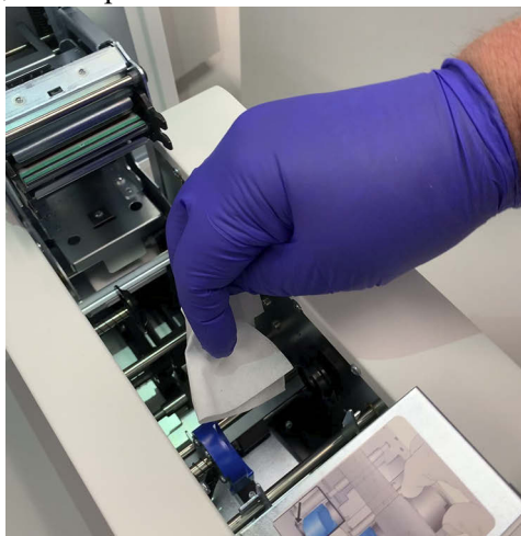
Фигура 8-10 Избършете транспортните ролки на принтера за предметни стъкла
