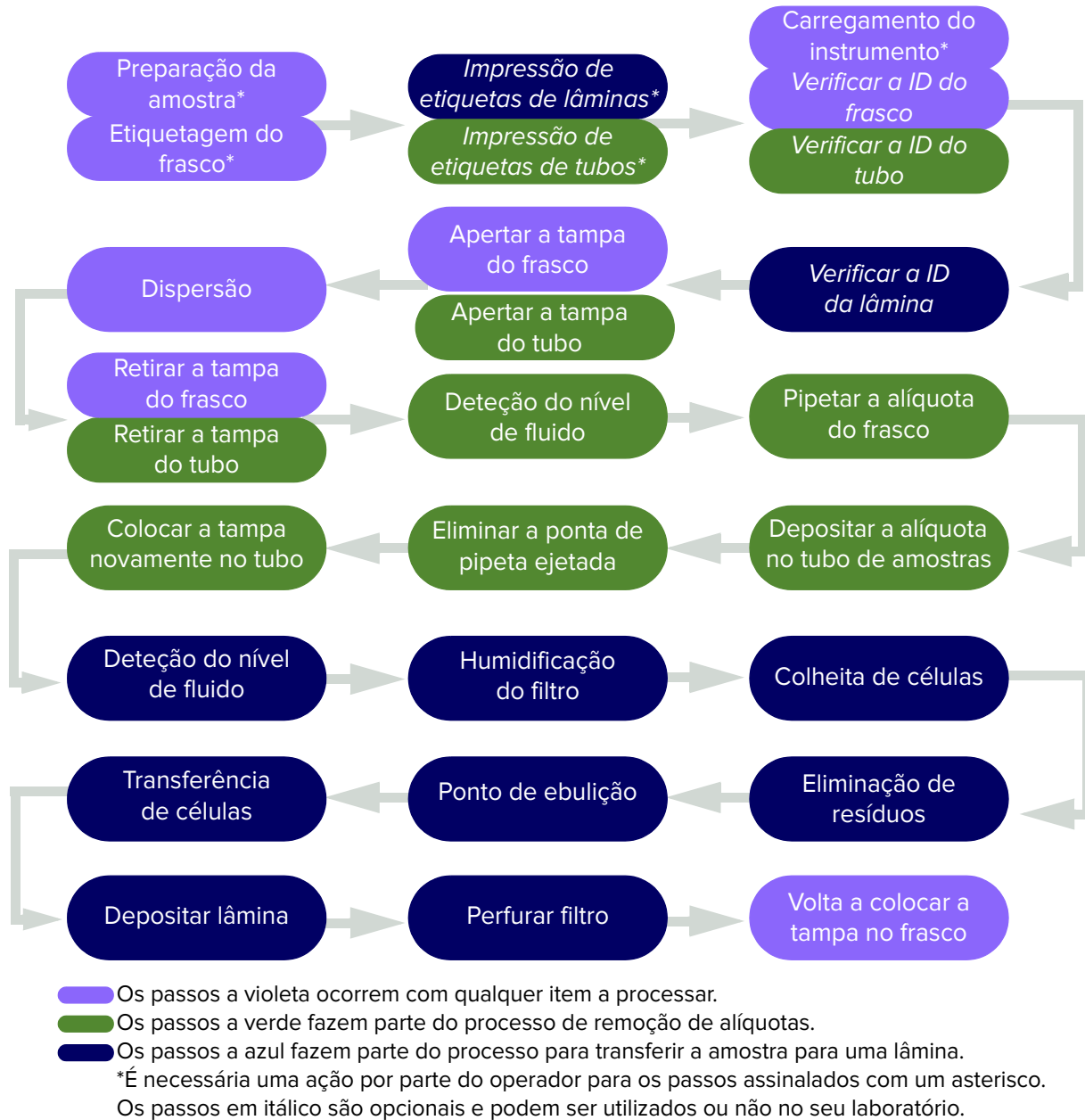
Figura 1-3 Processamento da lâmina e remoção da alíquota no Processador ThinPrep™ Genesis™
