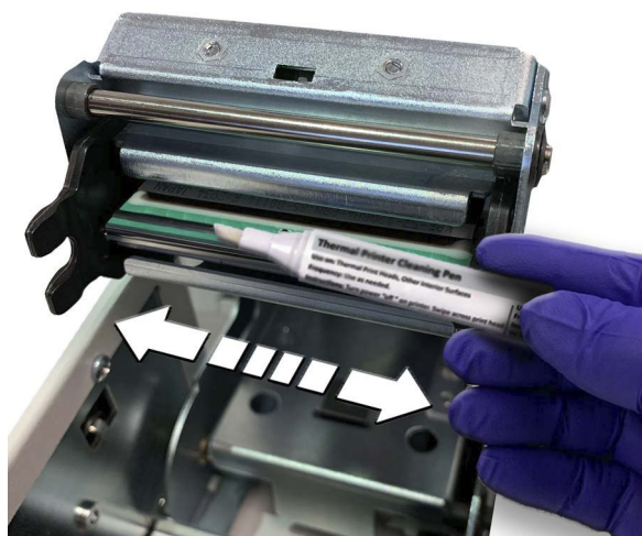
Figura 8-7 Passe a caneta de limpeza através da cabeça de impressão da impressora de lâminas
