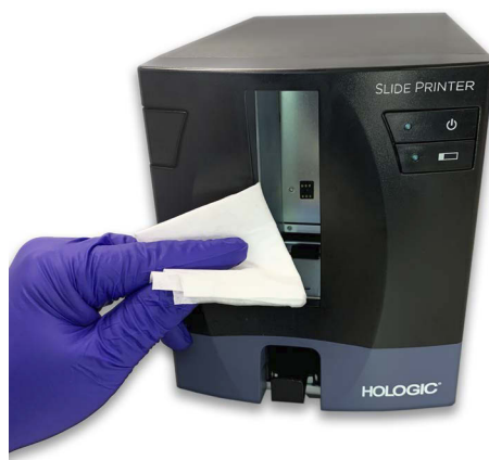
Figura 8-11 Limpar o rolo de entrada na impressora de lâminas
