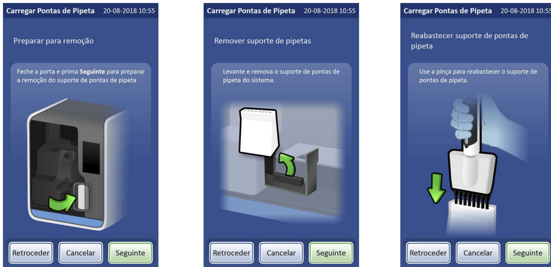
Figura 7-11 Carregar pontas de pipetas no seu respectivo suporte
