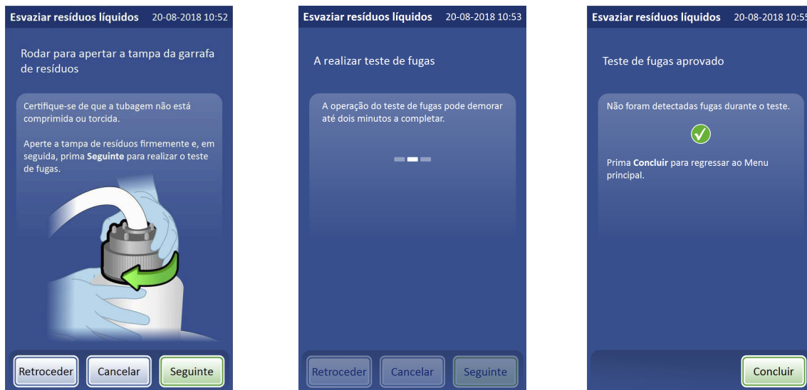
Figura 8-17 Apertar a tampa e efetuar um teste de fugas no sistema de resíduos
