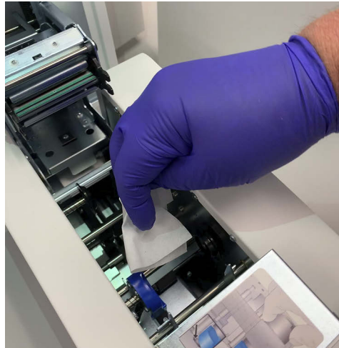
Figura 8-10 Pulire i rulli di trasporto della stampante vetrini
