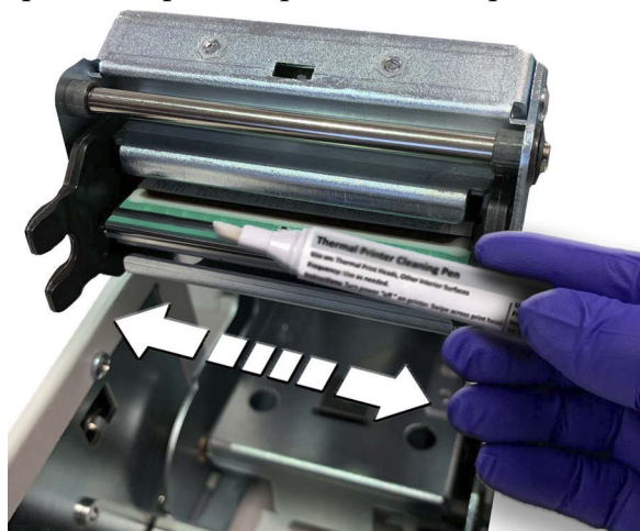
Figura 8-7 Passare la penna di pulizia sulla testina di stampa della stampante vetrini
