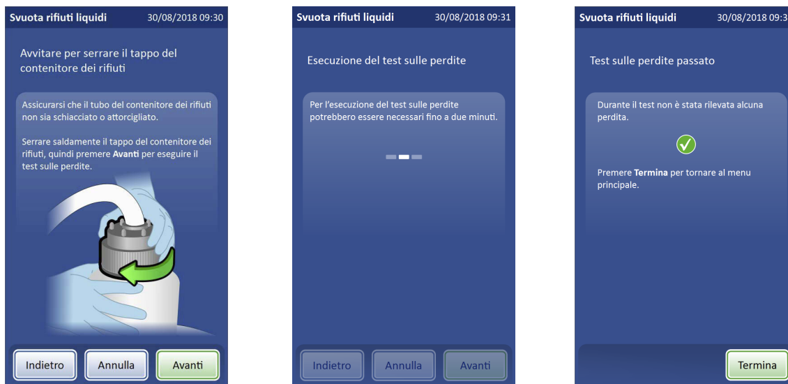
Figura 8-17 Serrare il tappo ed eseguire un test sulle perdite del sistema di scarico
