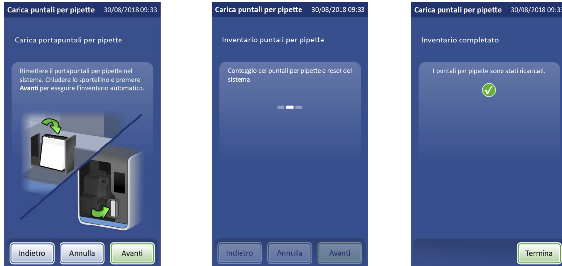
Figura 7-12 Reinserire il portapuntali per pipette caricato
