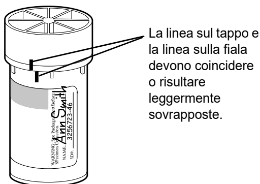
Figura 3-1 Allineamento del tappo della fiala
