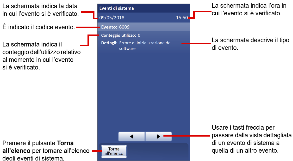
Figura 6-71 Dettagli degli eventi di sistema
