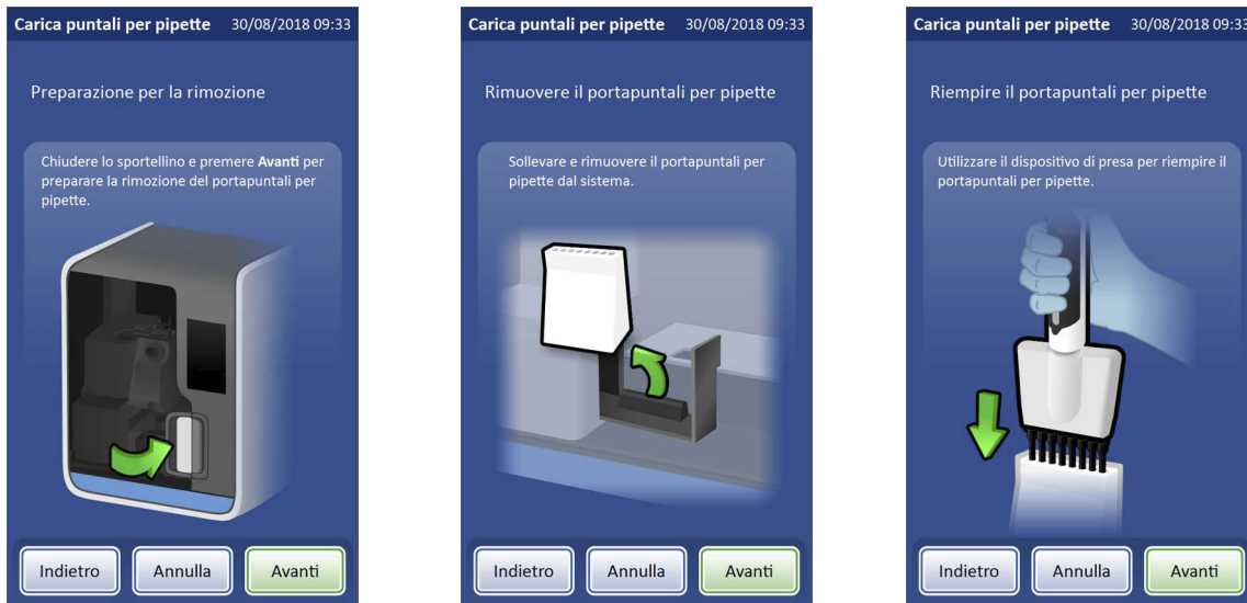
Figura 7-11 Caricare i puntali per pipette nel portapuntali
