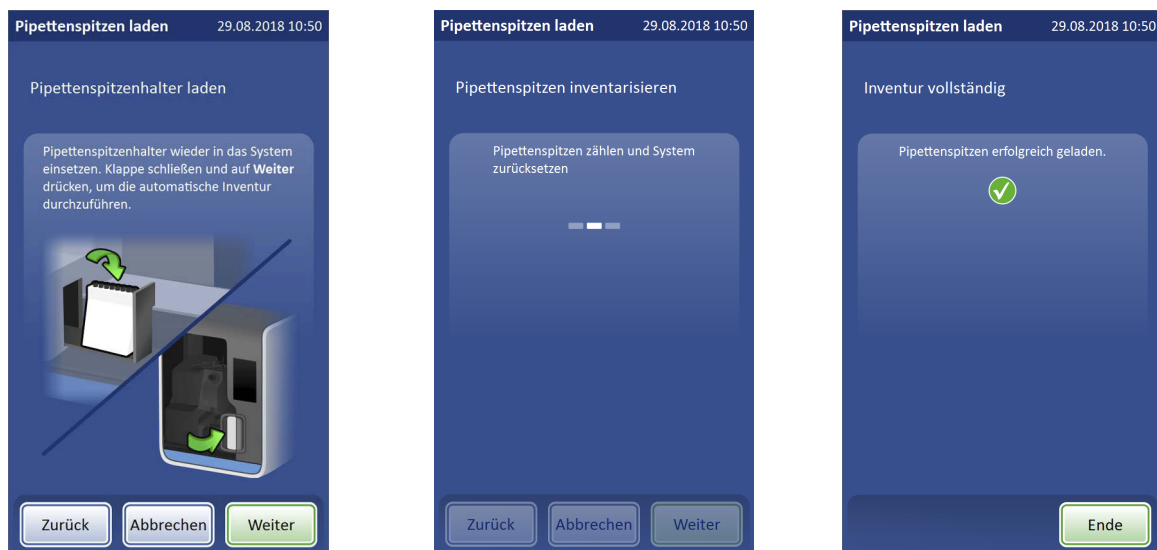
Abbildung 7-12 Beladenen Pipettenspitzenhalter wieder einsetzen
