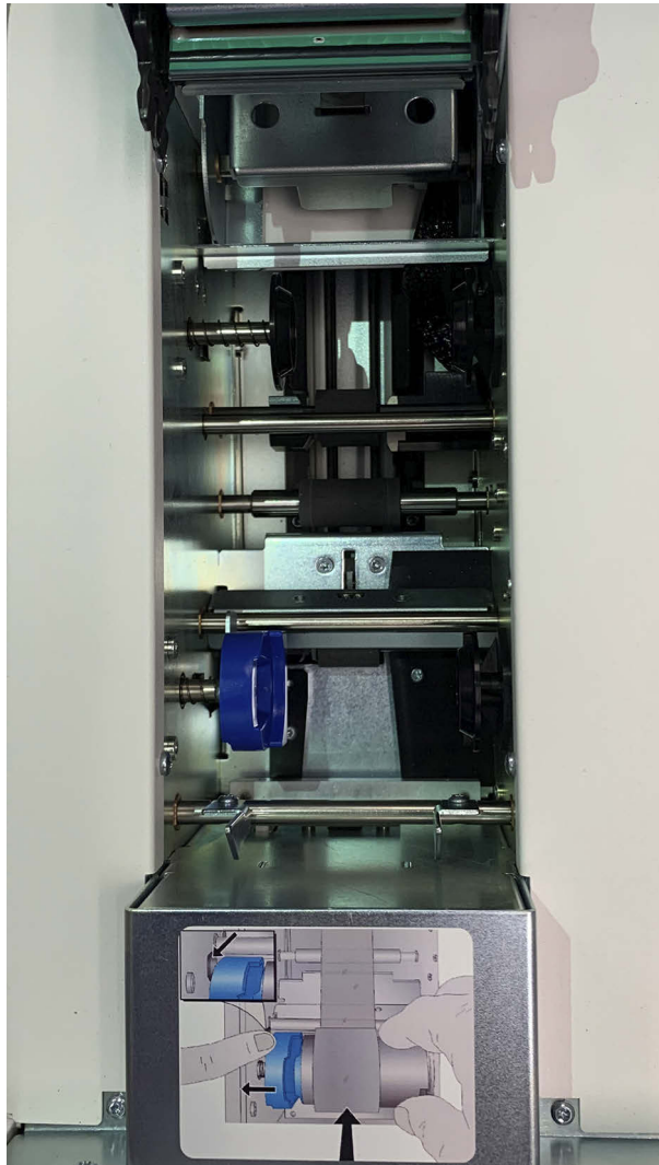
Abbildung 8-9 Transportrollen des Objektträgerdruckers
