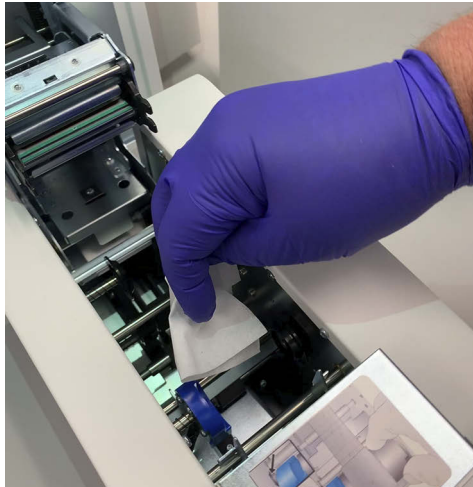
Abbildung 8-10 Transportrollen des Objektträgerdruckers abwischen
