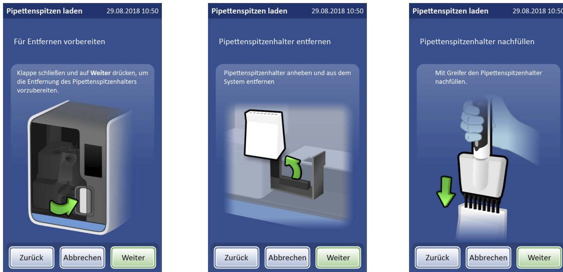
Abbildung 7-11 Die Pipettenspitzen in den Pipettenspitzenhalter laden.
