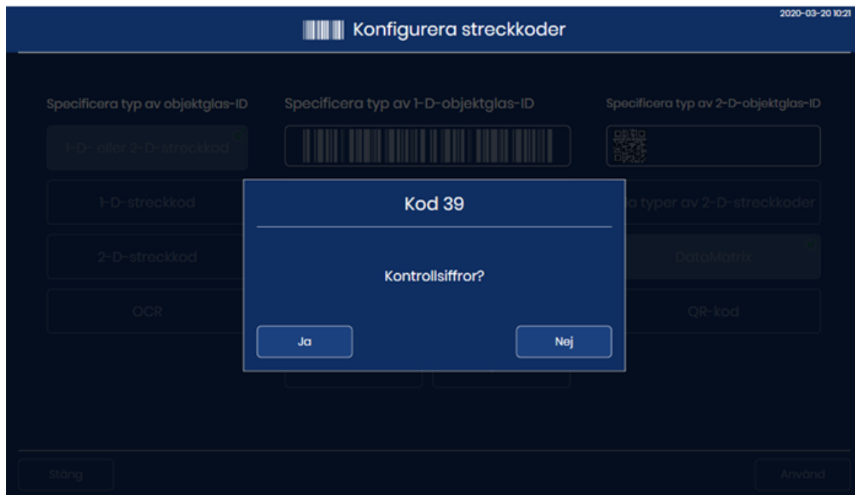
Figur 3-27 Konfigurera streckkoder: Välj Användning av kontrollsiffra för Interleaved 2 of 5 och för kod 39
