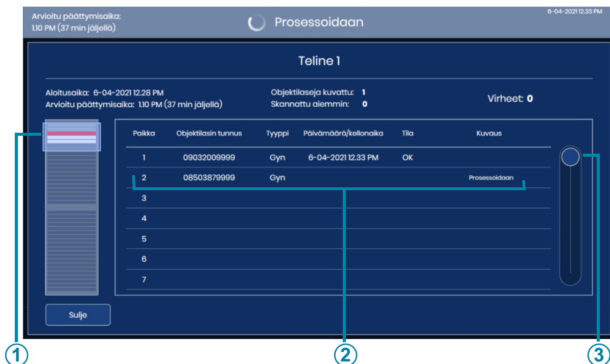
Kuva 4-15 Prosessoinnin aikana ilmenevä objektilasitapahtuma
