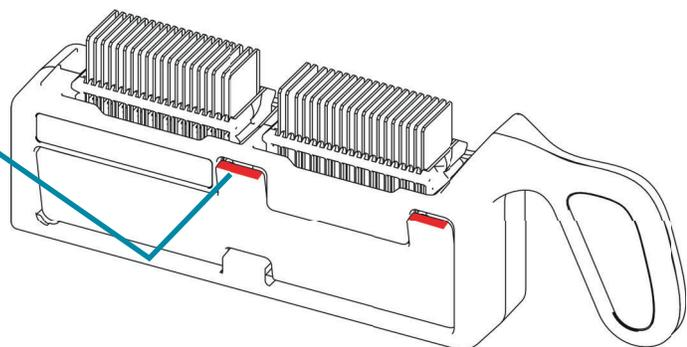
**Figura 4–8 Carregar lâminas no suporte de lâminas**
