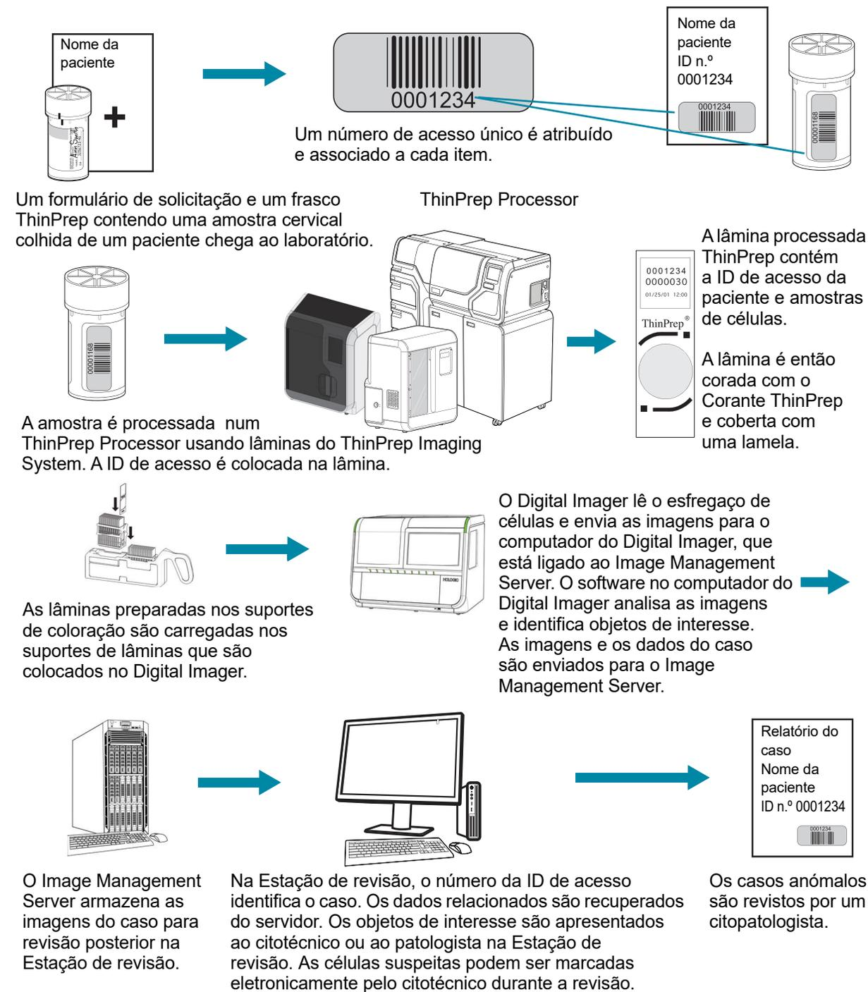
Figura 1-2 Fluxo laboratorial de casos ThinPrep™ Pap Test
