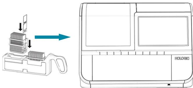
As lâminas ThinPrep preparadas são carregadas num suporte de lâminas, que é carregado no Digital Imager.
