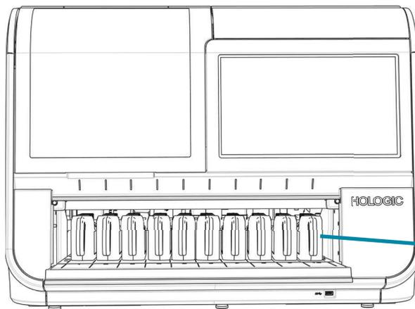
Suportes de lâminas, carregados pelo operador
