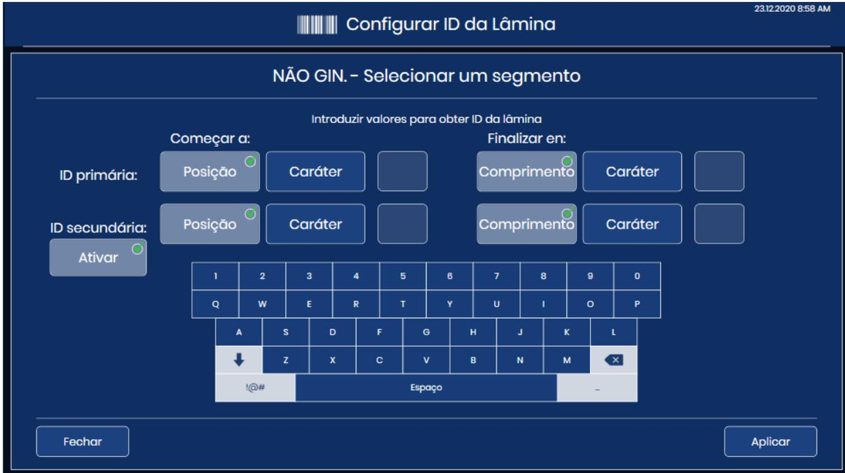
**Figura 3-35 Configurar ID da Lâmina para Lâminas Não Gin. com ID primária e ID secundária**
