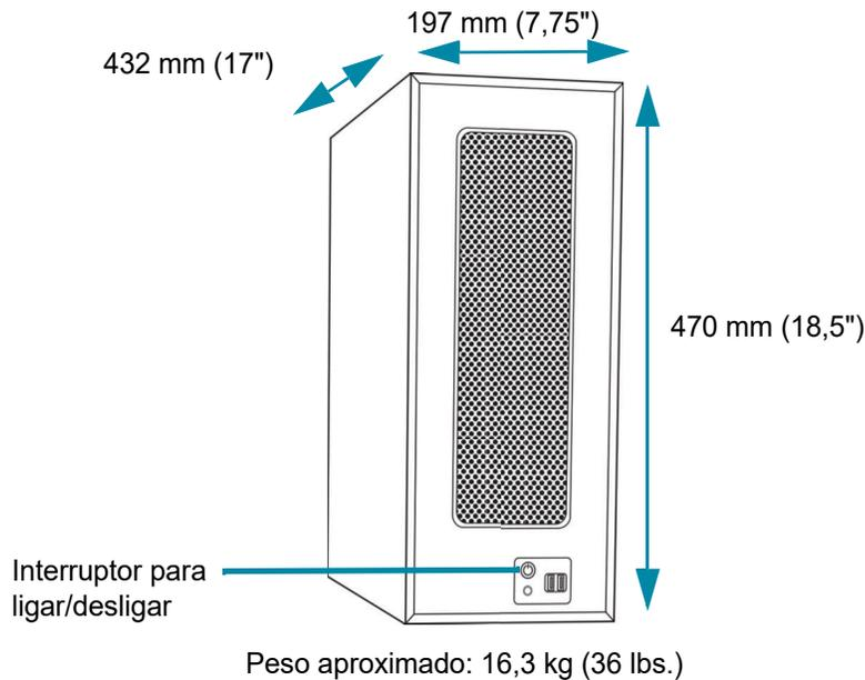
**Figura 1-14 Dimensões do computador do Digital Imager**
