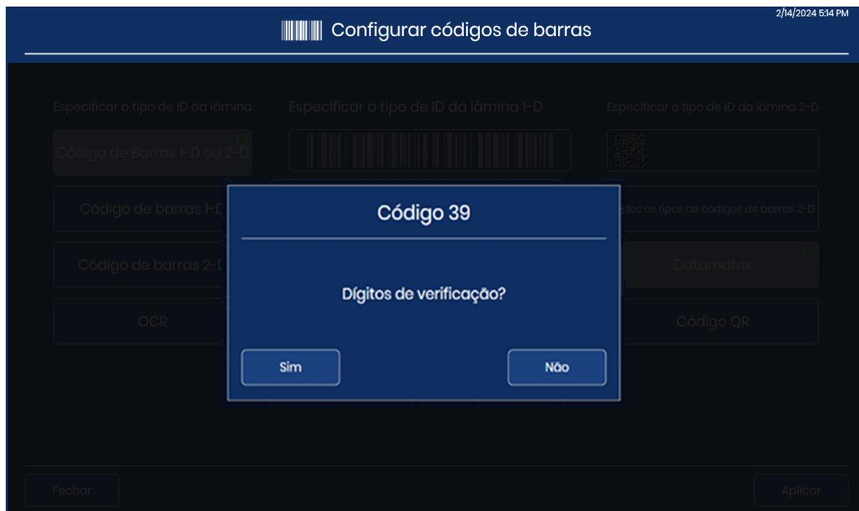
**Figura 3-29 Configurar códigos de barras: escolha o uso de dígitos de verificação para Interleaved 2 de 5 e o Código 39**
