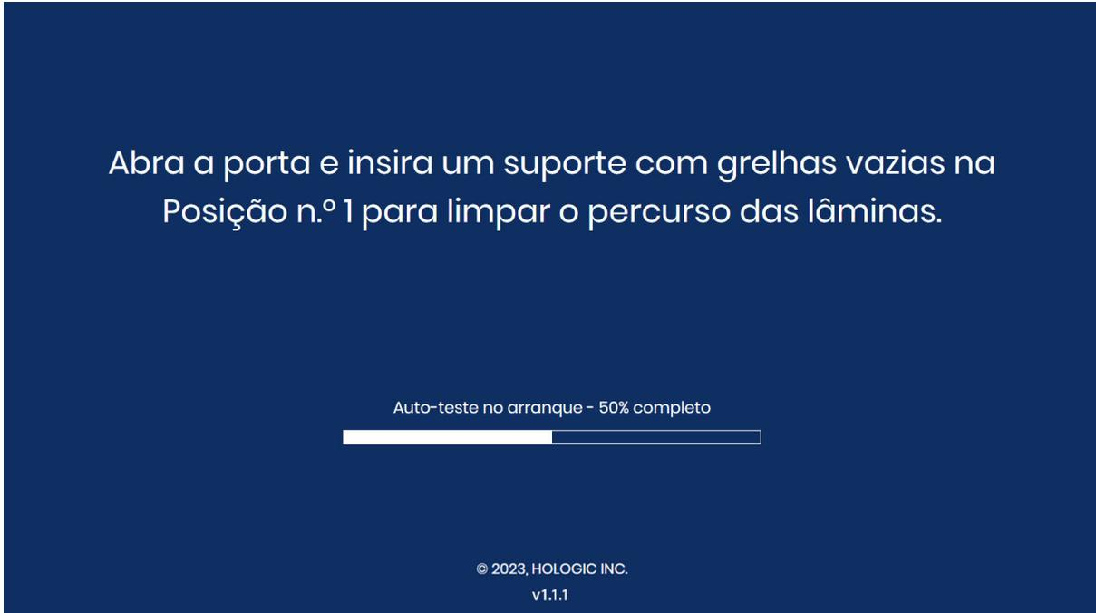
**Figura 6-6 Recuperação do erro assistida pelo utilizador: carregar um suporte de lâminas vazio**
