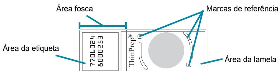
**Figura 6-11** Lâmina de microscópio ThinPrep Imaging System para amostras Gin.
