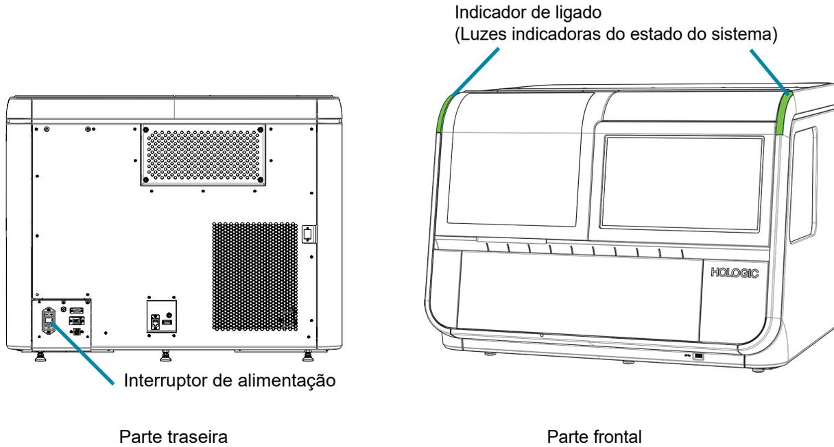
**Figura 4-2 Interruptor de alimentação do Digital Imager**
