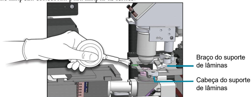
**Figura 5-8** Limpar o suporte de lâminas da estação de leitura de imagens
