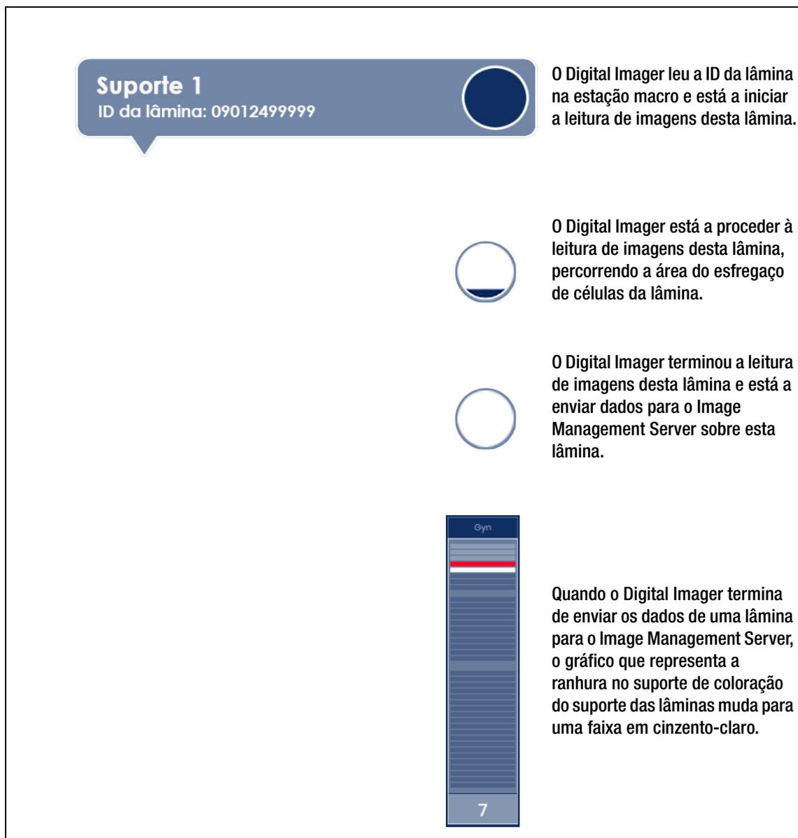
**Figura 3-5 Estado da transmissão de dados das lâminas**
