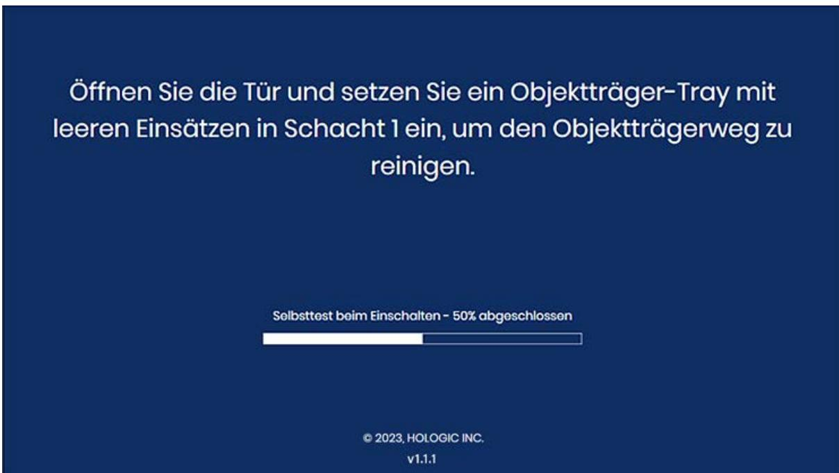
**Abb. 6-6 Benutzergestützte Fehlerbehebung: Laden eines leeren Objektträger-Trays**
