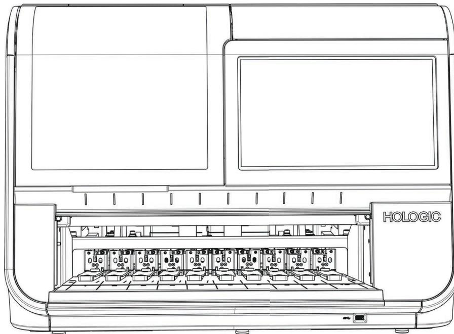
**Abb. 5-6 Objektträger-Trays entfernen, um das Objektträger-Traydeck zu abzuwischen**
