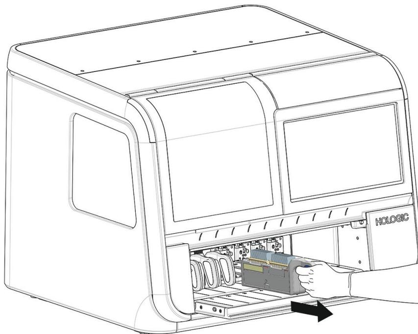
**Abb. 4-16 Objektträger-Tray aus dem Digital Imager entfernen**
