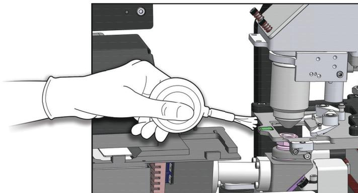
**Abb. 5-7 Verifizierungschip reinigen**
