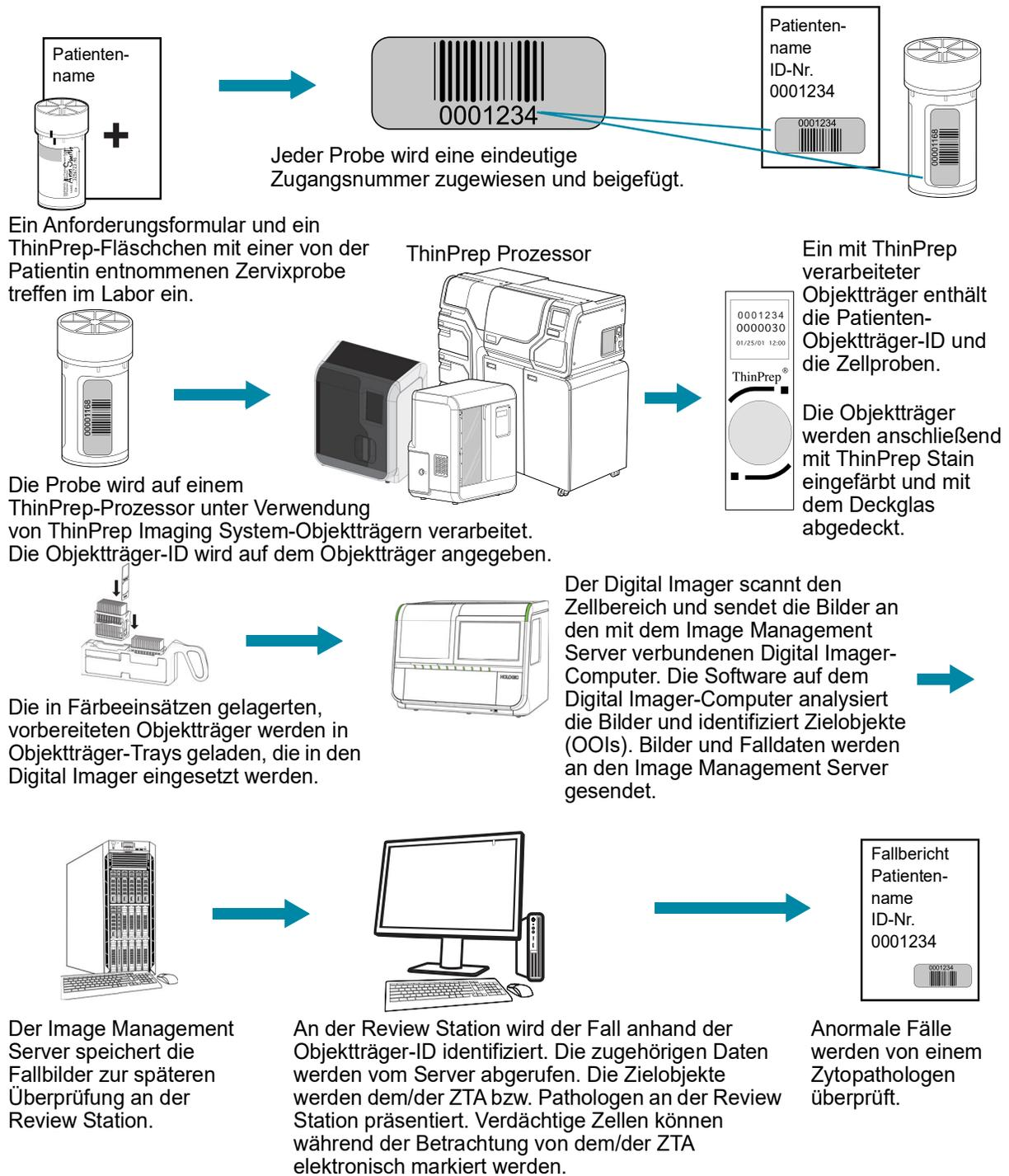
**Abb. 1-2 Ablauf im Labor für ThinPrep™ Pap-Tests**
