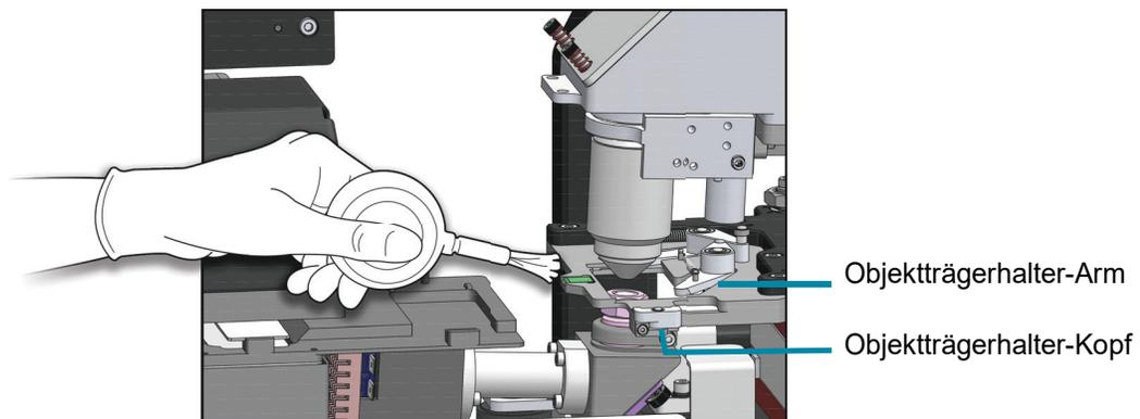
Abb. 5-8 Objektträgerhalter der Imaging Station reinigen
