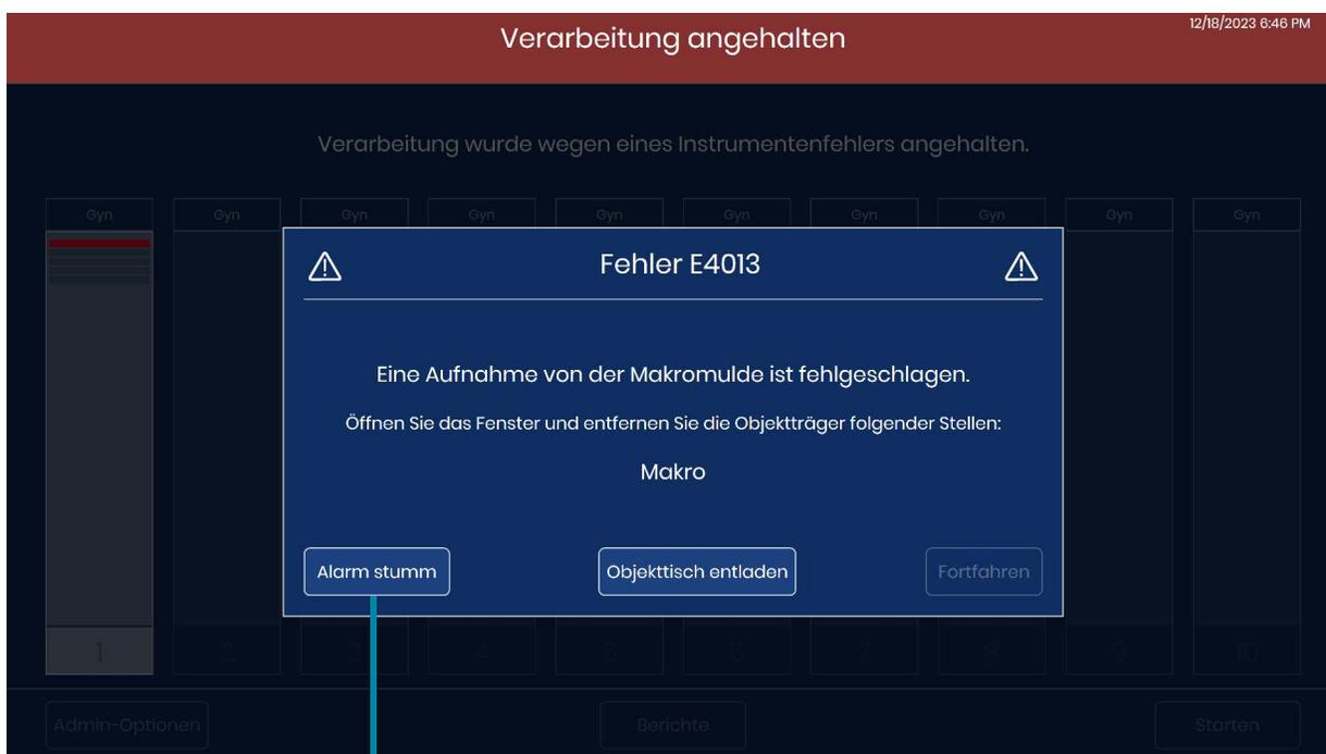
Die Schaltfläche **Alarm stumm** drücken und die Fehlermeldung weiter auf dem Bildschirm anzeigen lassen.
