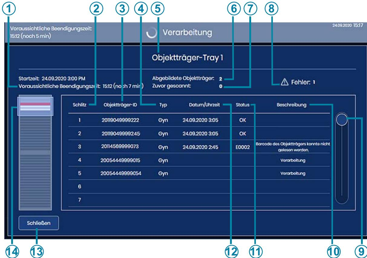
**Abb. 3-6 Bildschirm mit Details zu Objektträger-Trays (Tray 1, Beispiel)**
