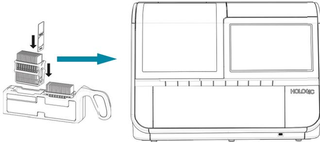
Vorbereitete ThinPrep-Objektträger werden in ein Objektträger-Tray geladen, der in den Digital Imager geladen wird.
