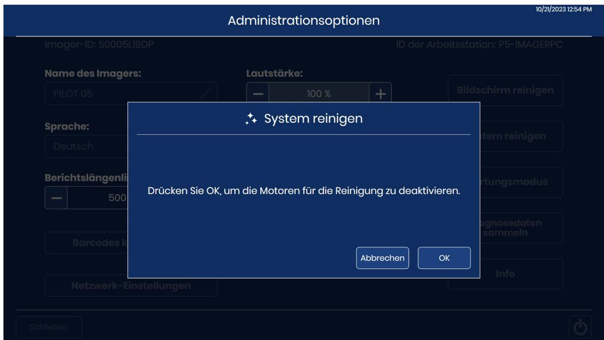
**Abb. 5-2 Modus System reinigen zum Abschalten der Motoren**
