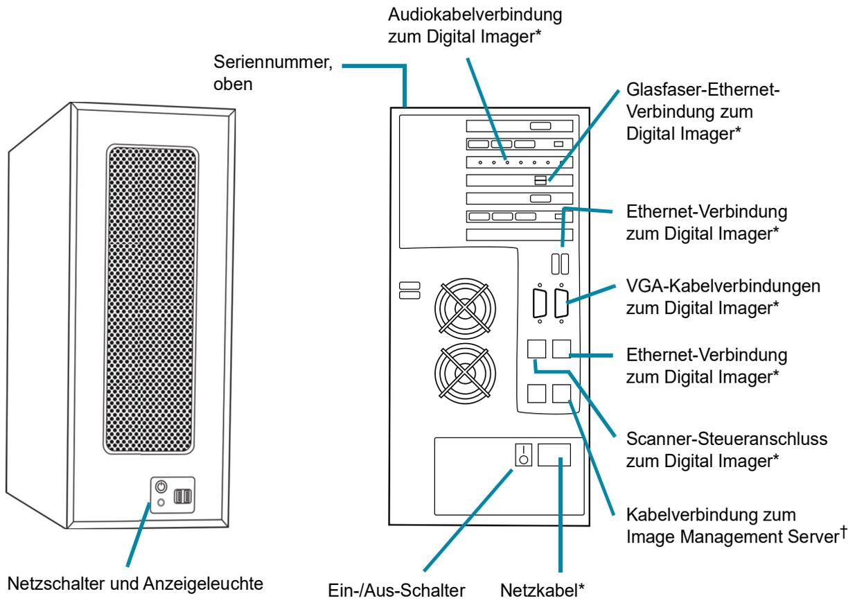
\* Von Hologic gelieferte Kabel und Leitungen
