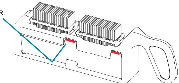
**Abb. 4-8 Laden von Objektträgern in das Objektträger-Tray**
