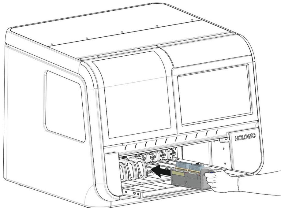
**Abb. 4-10 Beladenes Objektträger-Tray in eine leere Position schieben**
